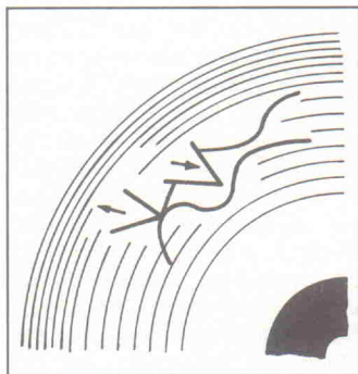
Bild 10. Gegenphasen auf der Schallplatte zwingen das Tonabnehmer-System zu vertikalen Bewegungen.
