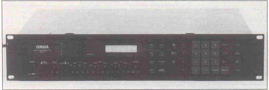
Bild 2. Modernes, digitales Hallgerät. Programmierbar, erschütterungsunempfindlich und mit maximalen Hallzeiten, wie sie in keinem natürlichen Raum vorkommen.
